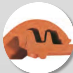
Per la giunzione verticale è stata sviluppata una nuova "Tecnica del labirinto": Cinque costole laterali stampate in modo speciale e particolarmente definite impediscono la penetrazione della pioggia anche con vento forte.
