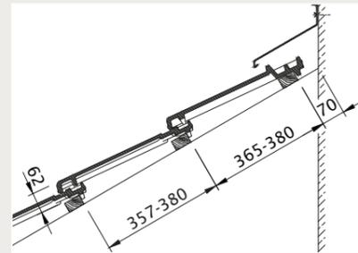
Wandanschluss (oben) mit Firstanschluss-Lüfterziegel
