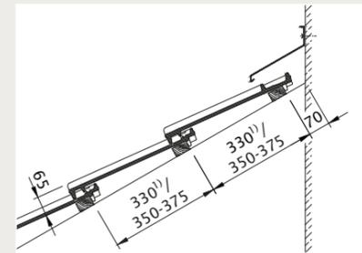
Wandanschluss (oben) mit Firstanschluss-Lüfterziegel
