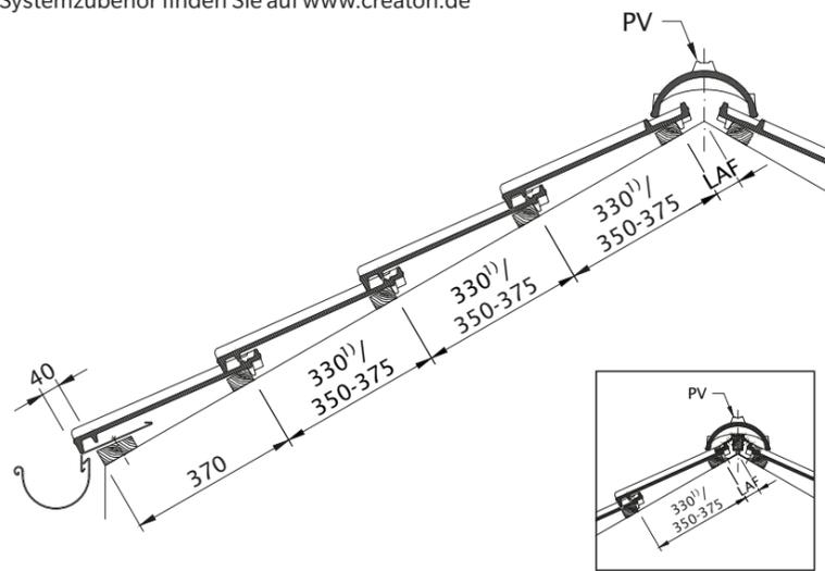
Dachquerschnitt Entlüftung über FALZ\*. Firstziegel trocken verlegt. LQ bis ca. 230 cm<sup>2</sup>/m. First. Nach DIN 4108 bis 23 m Sparrenlänge. Traufplattenabstand variabel.
