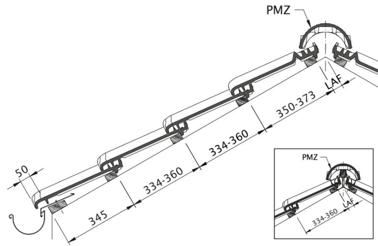
Dachquerschnitt Entlüftung über FALZ\*. Firstziegel trocken verlegt. LQ bis ca. 230 cm<sup>2</sup>/m. First. Nach DIN 4108 bis 23 m Sparrenlänge. Traufplattenabstand variabel.
