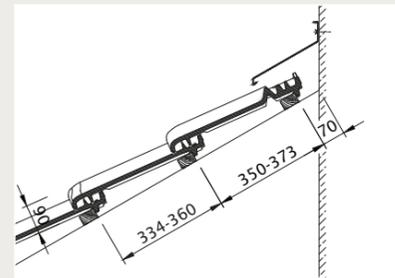
Wandanschluss (oben) mit Firstanschluss-Lüfterziegel
